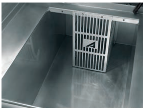
OCHRANNÝ KRYT MÍCHADLA
